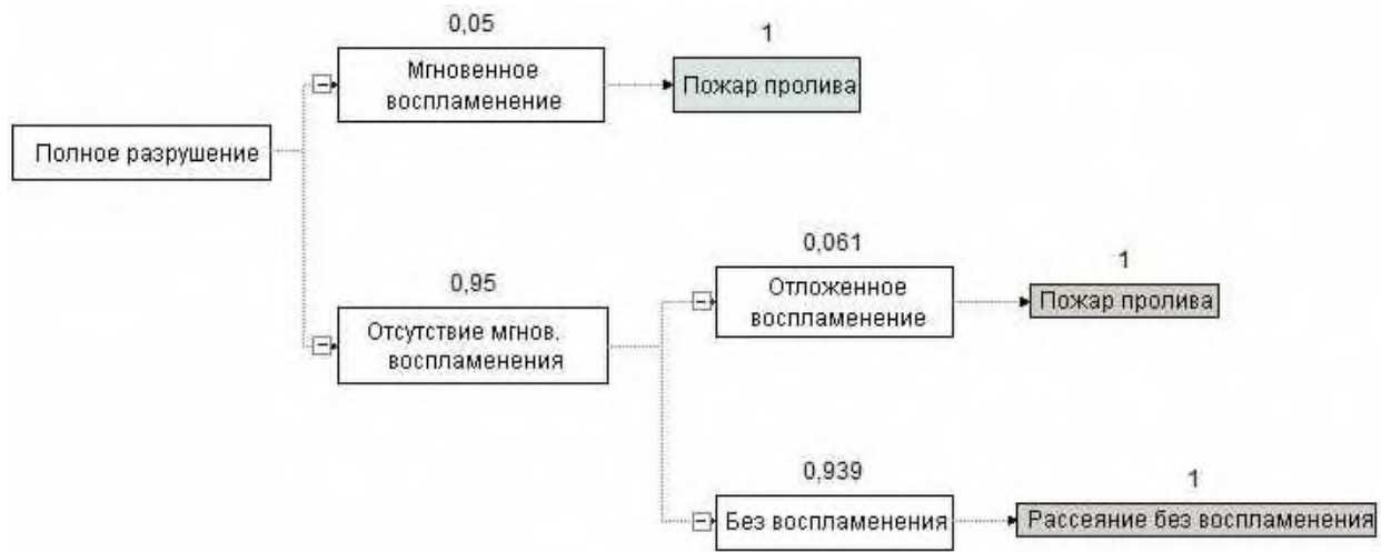
Рисунок 1 – Разгерметизация цистерны ТЗ
