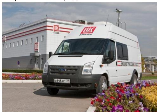
Рис. 1 - Передвижной экологический пост ПЭП-1-1М для контроля состояния атмосферного воздуха
