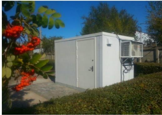
Рис. 2 - Автоматический пост контроля качества атмосферного воздуха
