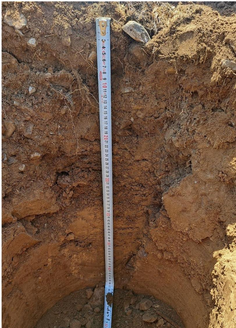
Рисунок 3.5 - Шурф №1. Техногенные поверхностные образования в границах работ
