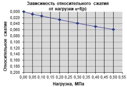
Испытание производилось на приборе компрессионного сжатия КППА 60/25 ДС (ИВК АСИС) по ГОСТ 12248.4-2020
