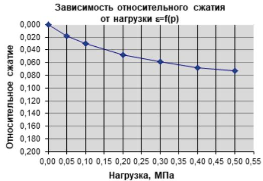
Испытание производилось на приборе компрессионного сжатия КППА 60/25 ДС (ИВК АСИС)
