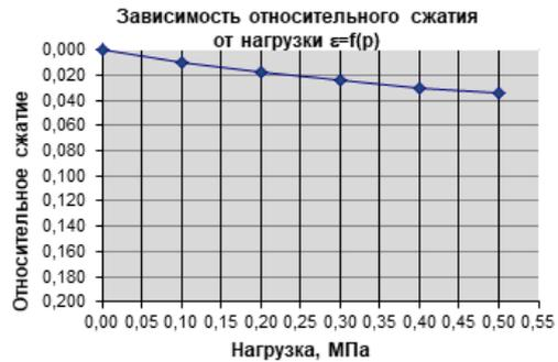
Испытание производилось на приборе компрессионного сжатия КППА 60/25 ДС (ИВК АСИС) по ГОСТ 12248.4-2020
