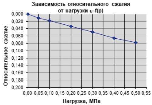
Испытание производилось на приборе компрессионного сжатия КППА 60/25 ДС (ИВК АСИС) по ГОСТ 12248.4-2020
