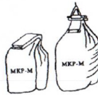
Рис. 2. Застропка мягких контейнеров типа МКР-М
