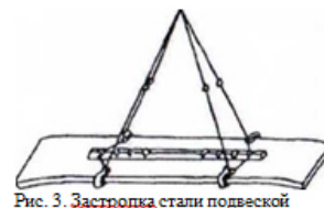
Рис. 3. Застровка стали подвеской КПЛс-10
