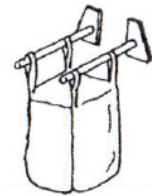
Рис. 3. Транспортировка МК погрузчиком
