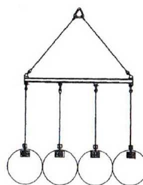
Рис. 2. Застропка рулонов в горизонтальном положении
