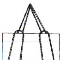
Рис. 4. Застропка рулона синтетическими (растительными) стропами «в удав»
