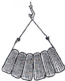
1. Строповка рулонов проволоки
