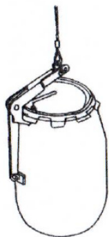
Рис. 2. Застропка синтетической бочки рычажным захватом
