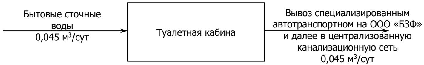
Рисунок 5.3.1 Схема системы бытовой канализации
