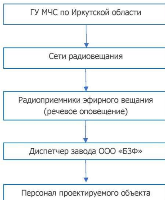
Рисунок 3.4 Принципиальная схема оповещения об угрозе возникновения ЧС природного и техногенного характера
