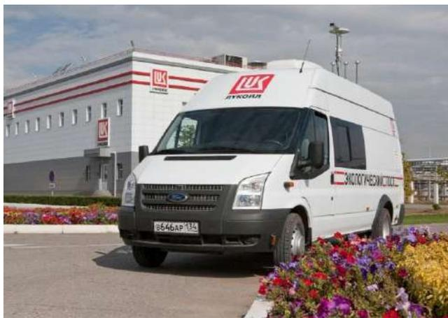
Передвижной экологический пост оборудован газоаналитической стойкой, метеорологическим комплексом, комплектом воздухозаборных устройств, системой жизнеобеспечения и автономным питанием. Он оснащен газоанализаторами, позволяющими измерять содержание основных загрязнителей в атмосферном воздухе.
