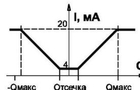
Рис. 5 – Выходная характеристика токового выхода ПРЭМ
