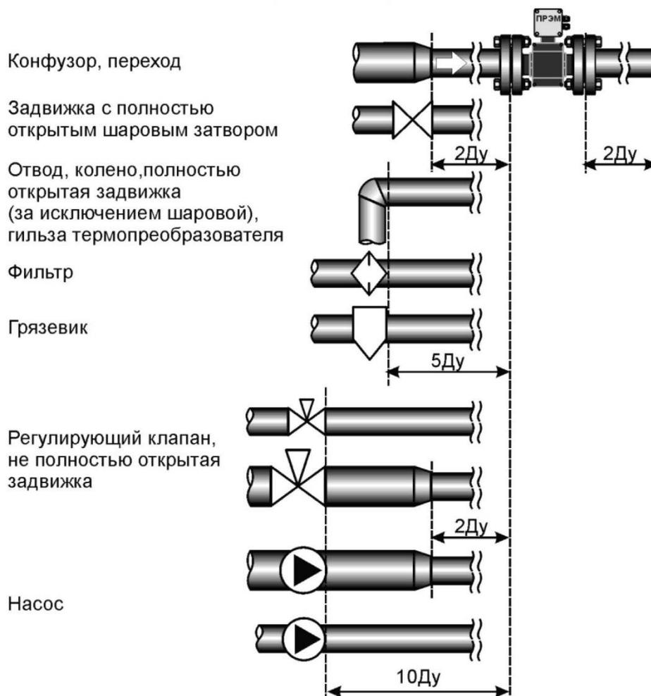
**Прямой участок** – прямолинейный отрезок трубопровода, не содержащий местных гидравлических сопротивлений (сужения, расширения, задвижки, клапаны, термопреобразователи и др.).
