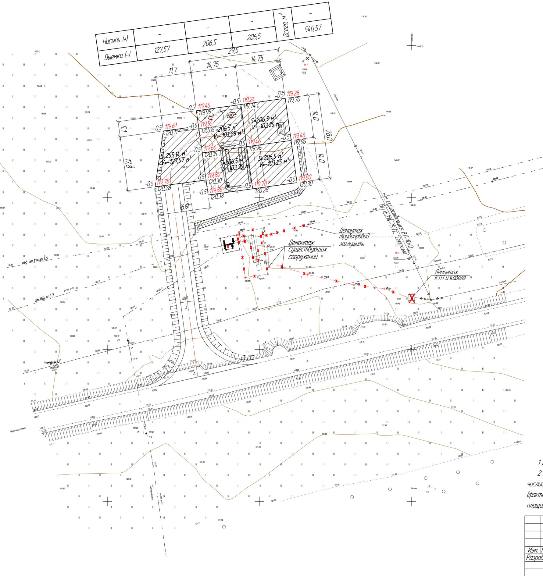
1 Данный чертеж выполнен на удаление плодородного грунта толщиной 0,5 м.
