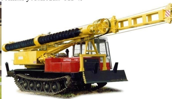
**Рисунок 1** - Бурильно-сваебойная машина БМ-811-01 и БМ-831-01
