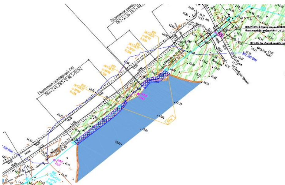
Рисунок 1.1 - Расположения газопровода относительно озера без названия
