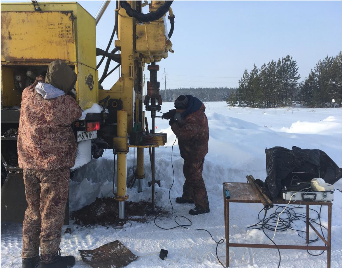
Рисунок 4 – Испытания грунтов статическим зондированием
