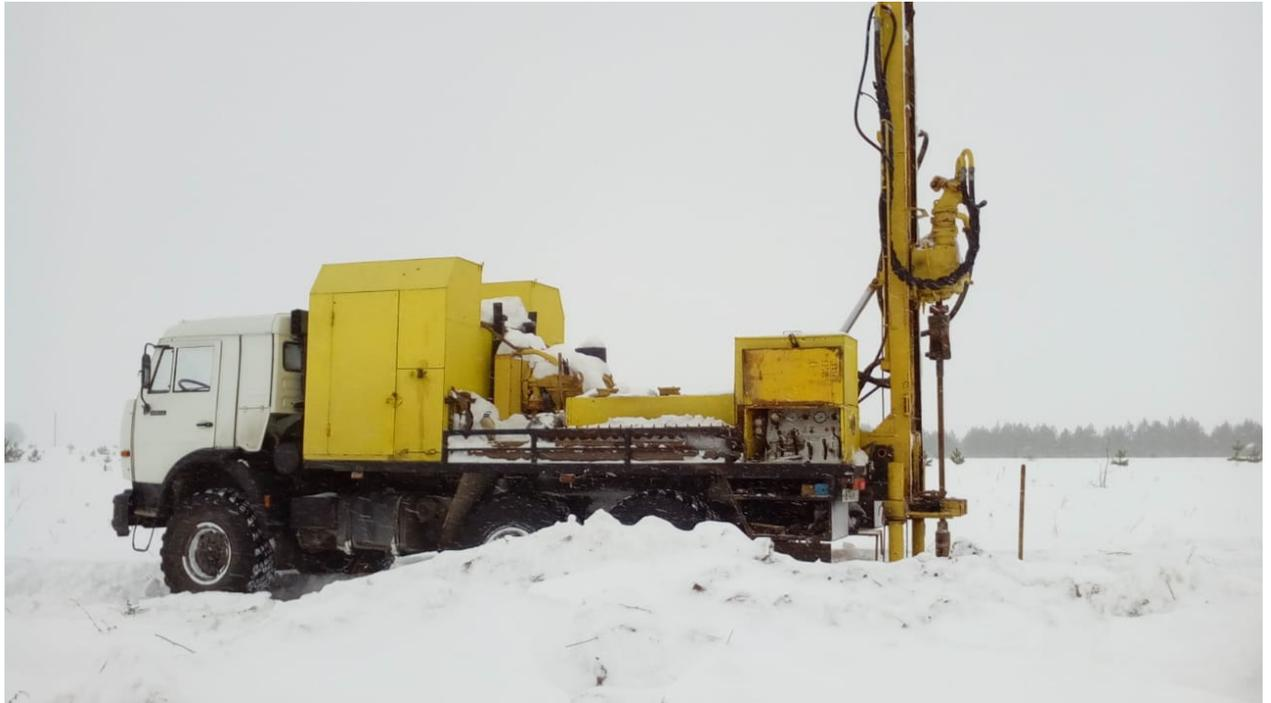
Рисунок 2 - Бурение скважин выполнено установкой УРБ -2А-2
