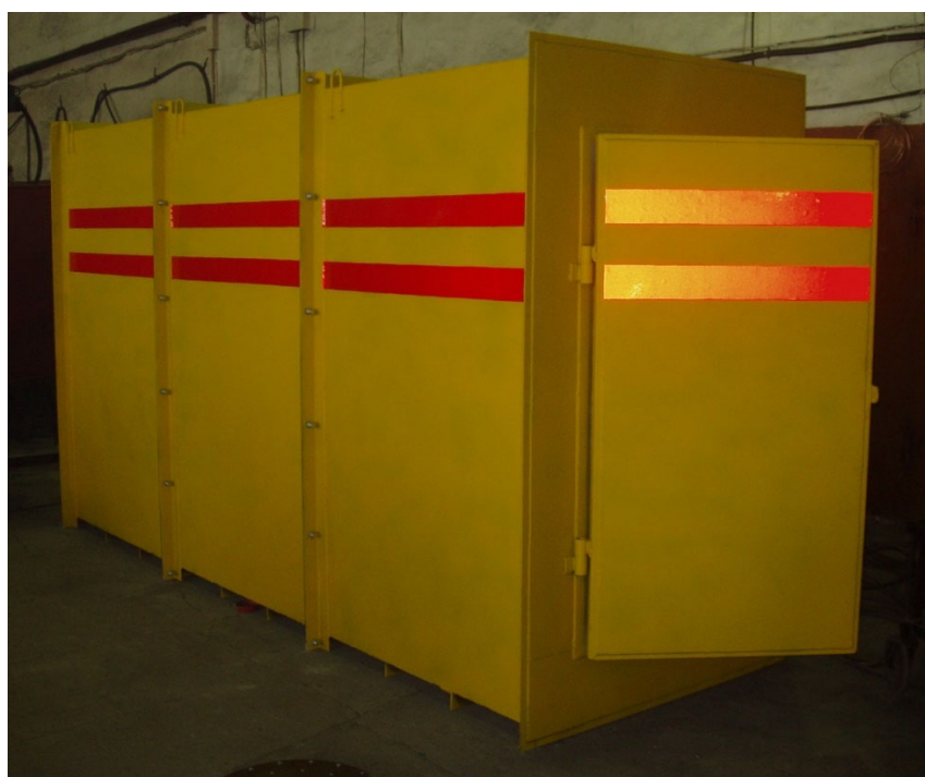
Рисунок 6.1. Контейнер подземного противопожарного склада.
