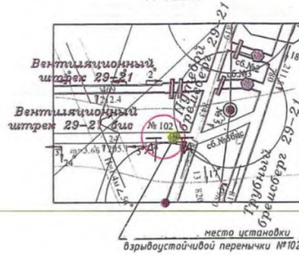
Место установки взрывоустойчивой перемычки №102 пласт 29а участок Антоновский-2 М 1:2000
