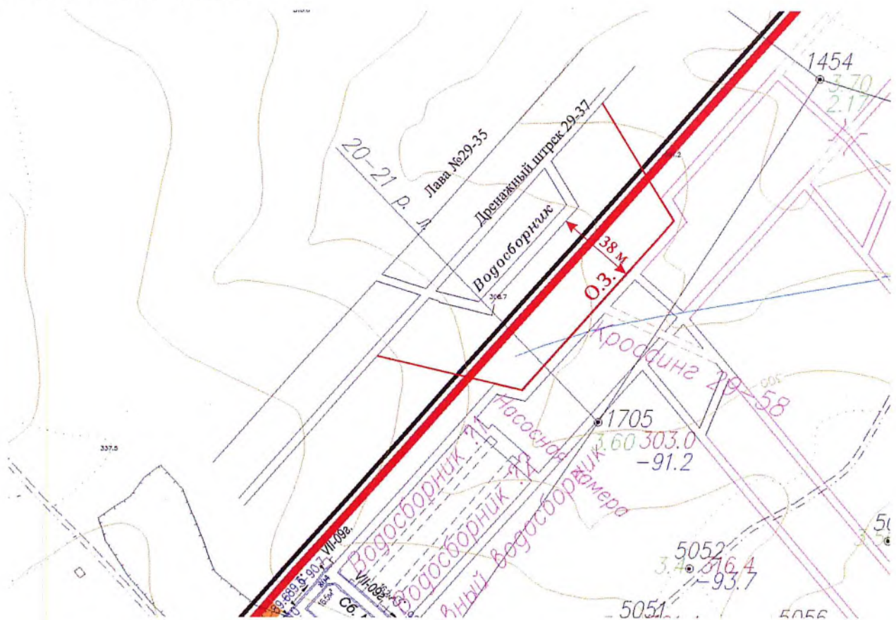
Рис.14.1. Выкопировка из плана горных выработок шахты «Большевик» с водосборником №3 шахты «Антоновская»
