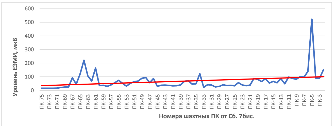
Рисунок 6-2. График изменения ЕЭМИ вдоль Трубного бремсберга 29-21
