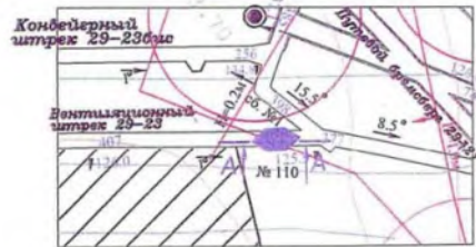
ВЫКОПИРОВКА С ПЛАНА ГОРНЫХ РАБО пласт 29а участок Антоновский-2 М 1:2000
