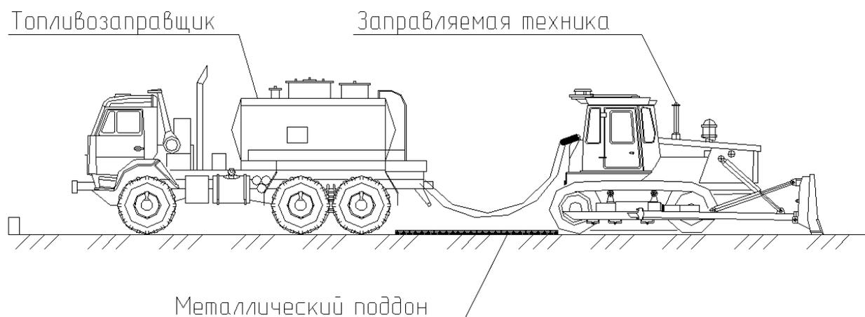
Рисунок 1 – Схема заправки строительной техники
