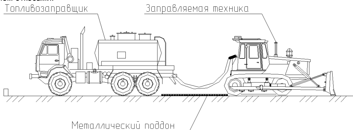
Рисунок 1 – Схема заправки строительной техники
