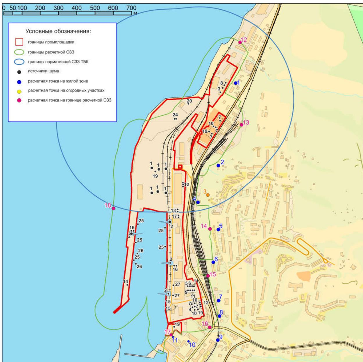
Рисунок 4.3–1: Схема расположения источников шума и расчетных точек
