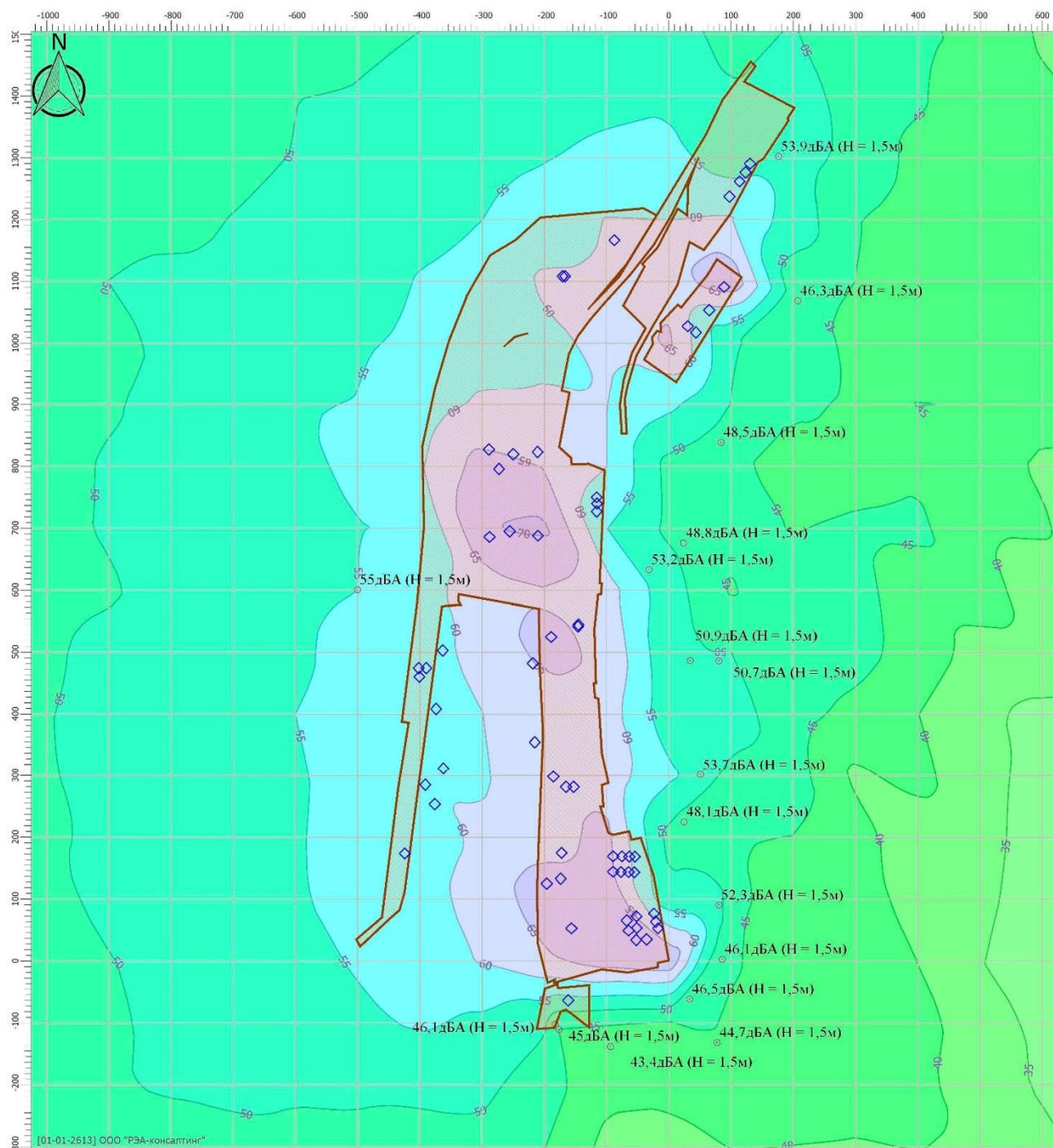
Рисунок 4.3–2: Графические результаты расчетного моделирования зон распространения звука в дневное время (шаг сетки – 100 м)
