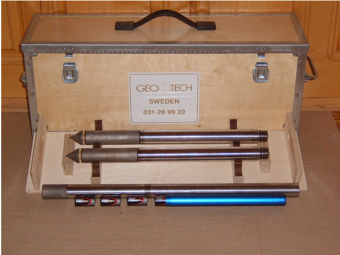
Зонды с блоком преобразования в акустический сигнал и памятью
