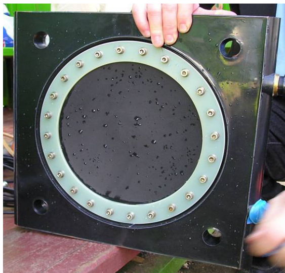
Электродинамический излучатель «бумер»
