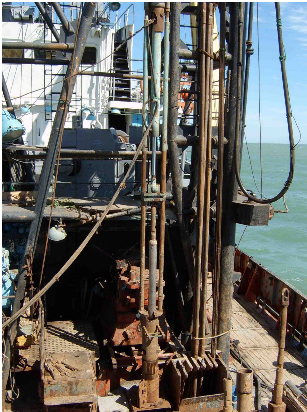
Рисунок 4. Устройство пробоотбора (методом вдавливания)
