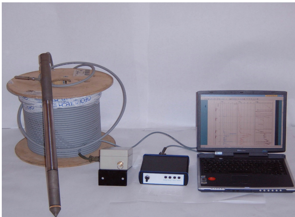
Регистрирующая аппаратура в кабельном варианте передачи данных
