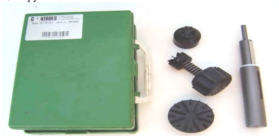
Рисунок 5.8 – Средства для экспресс-испытаний глинистых грунтов
