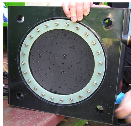
Электродинамический излучатель "бумер"
