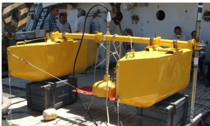
Забортное устройство для буксировки приёмоизлучающих компонентов "бумер"
