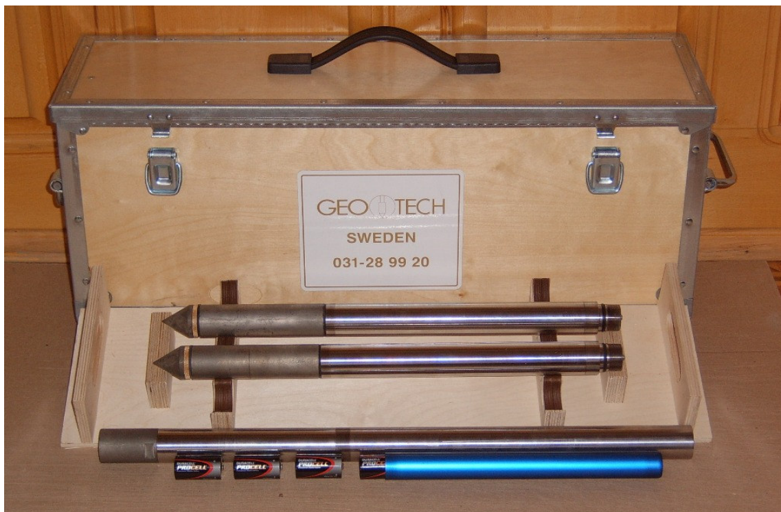
Зонды с блоком преобразования в акустический сигнал и памятью
