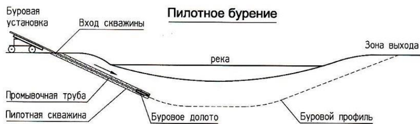
1. Начало бурения пилотной скважины
