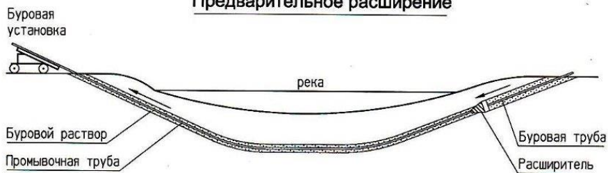
3. Начало расширения пилотной скважины.
