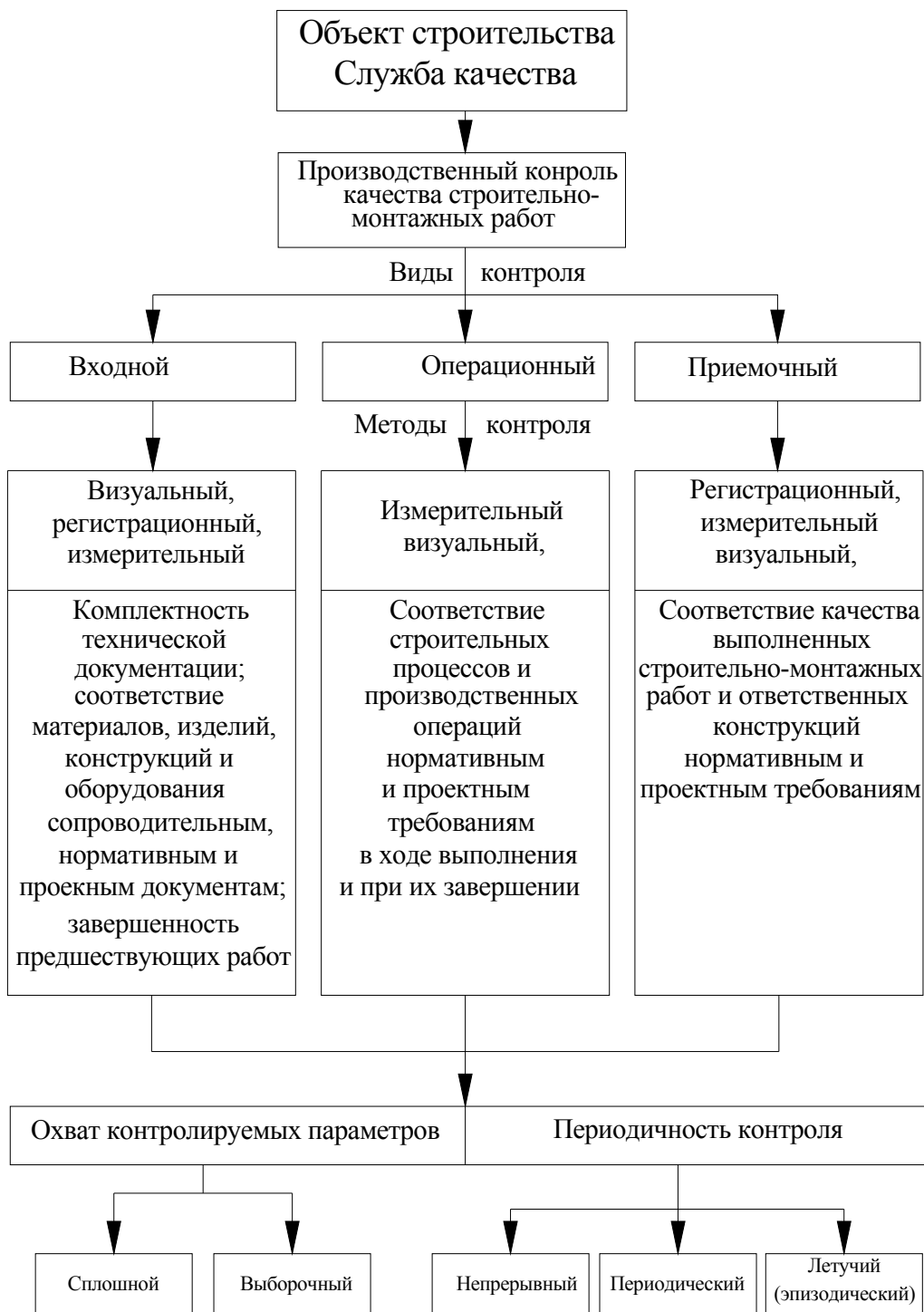
Рисунок 1 - Схема производственного контроля качества строительно-монтажных работ
