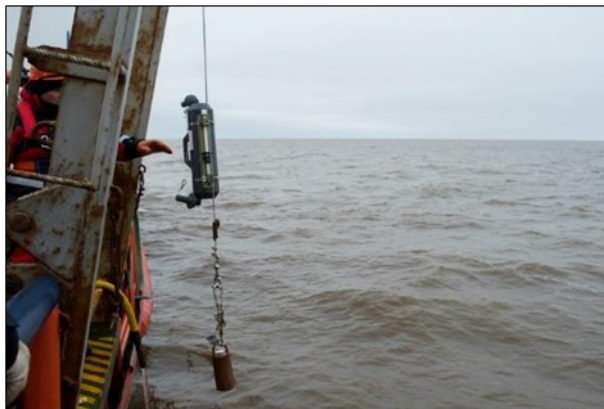
Рис. 6.3 - 1. Отбор проб воды на гидрохимические исследования с помощью батометра Нискина
