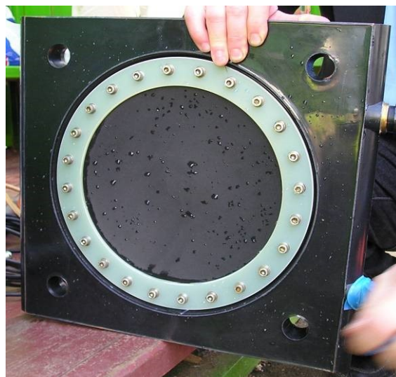
Электродинамический излучатель «бумер»
