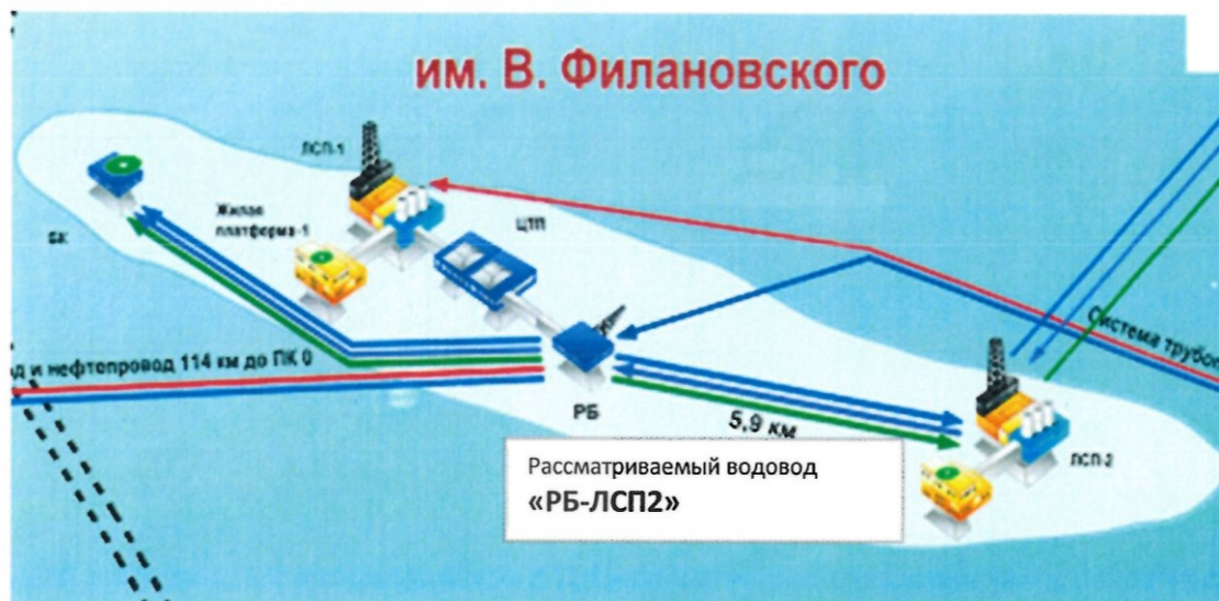
Рисунок 1.2 - Обзорная схема расположения объекта по проекту «Строительство водовода РБ – ЛСП-2 месторождения им. В. Филановского» на лицензионном участке ООО «ЛУКОЙЛ-Нижневолжскнефть»
