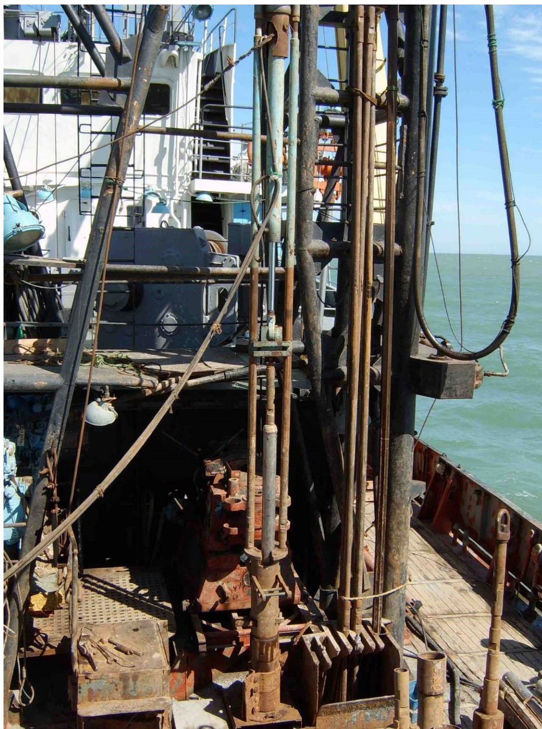
Рисунок 4. Устройство пробоотбора (методом вдавливания)
