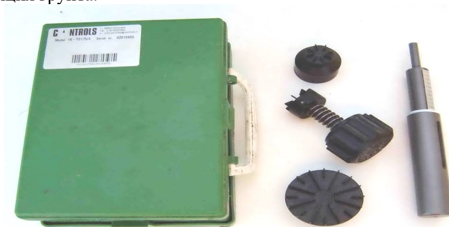
Рисунок 5.7 - Средства для экспресс-испытаний глинистых грунтов
