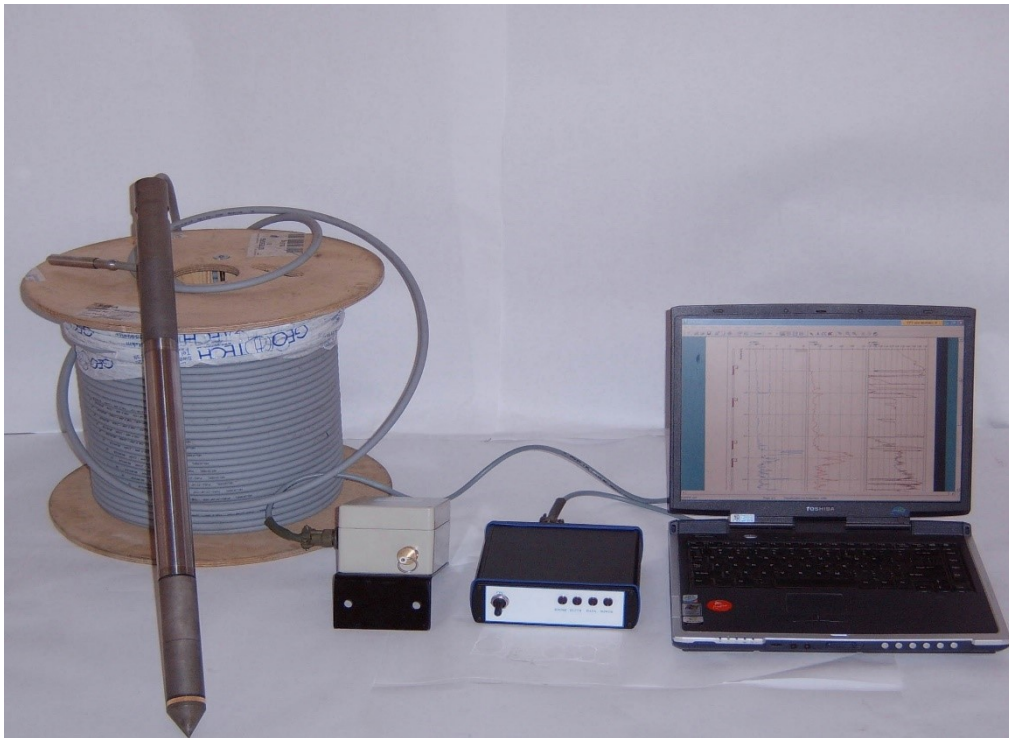
Регистрирующая аппаратура в кабельном варианте передачи данных
