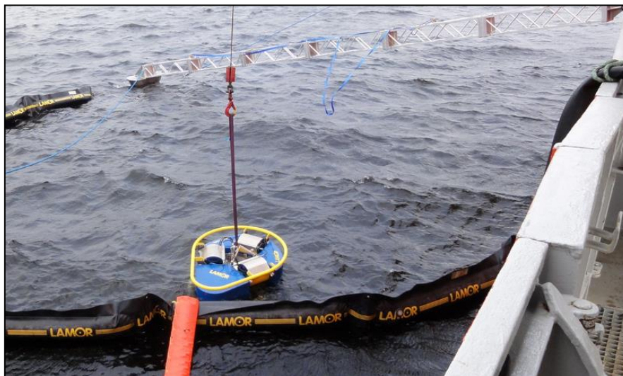
Рисунок 2.6 - Нефтесорбная система «Lamor Multi MK II»
