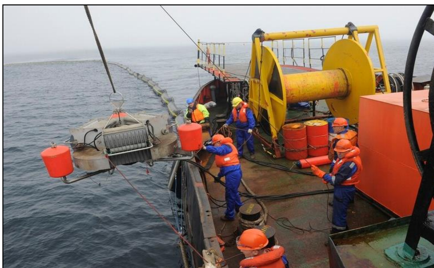
Рисунок 2.5 - Установка скиммера Desmi DBD в море
