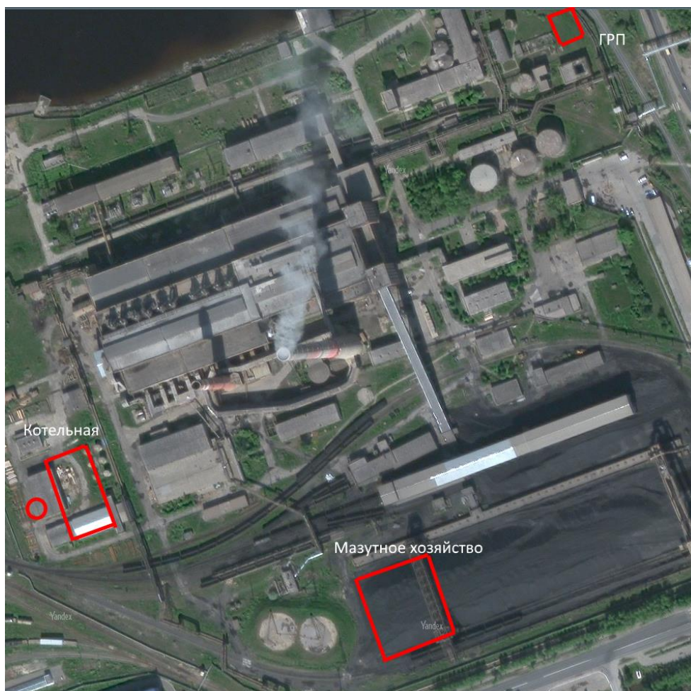
Рисунок 1.1-2. Расположение объектов строительства
