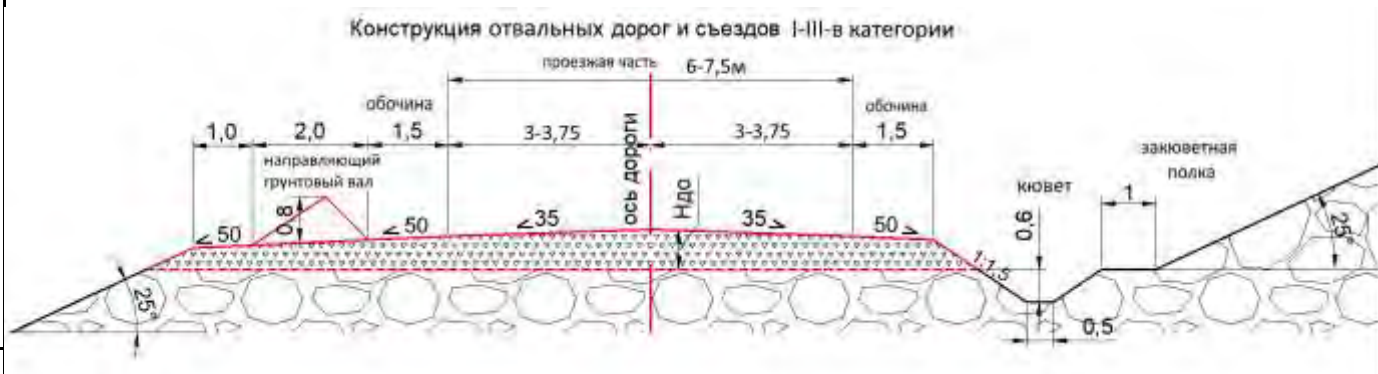
Рисунок 2.1 - Конструктивный поперечный профиль отвалных автодорог и съездов
