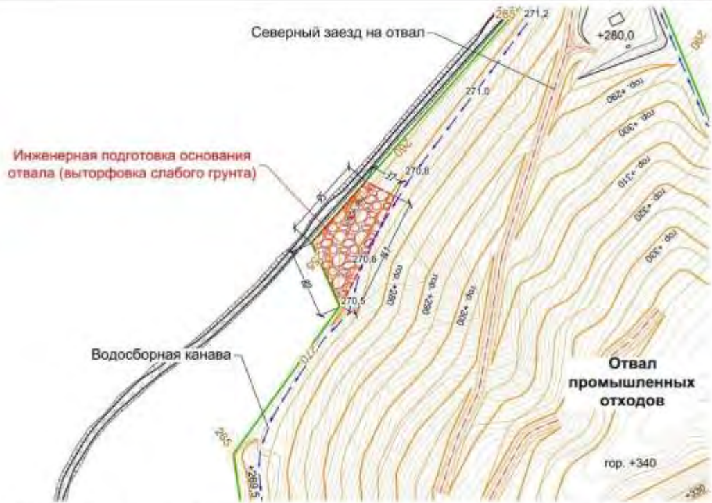
Рисунок 8.2 – Размещение инженерной подготовки основания в северо-западной части отвала
