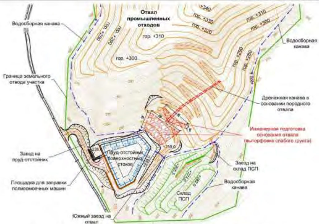
Рисунок 8.3 – Размещение инженерной подготовки основания в южной логовой части отвала
