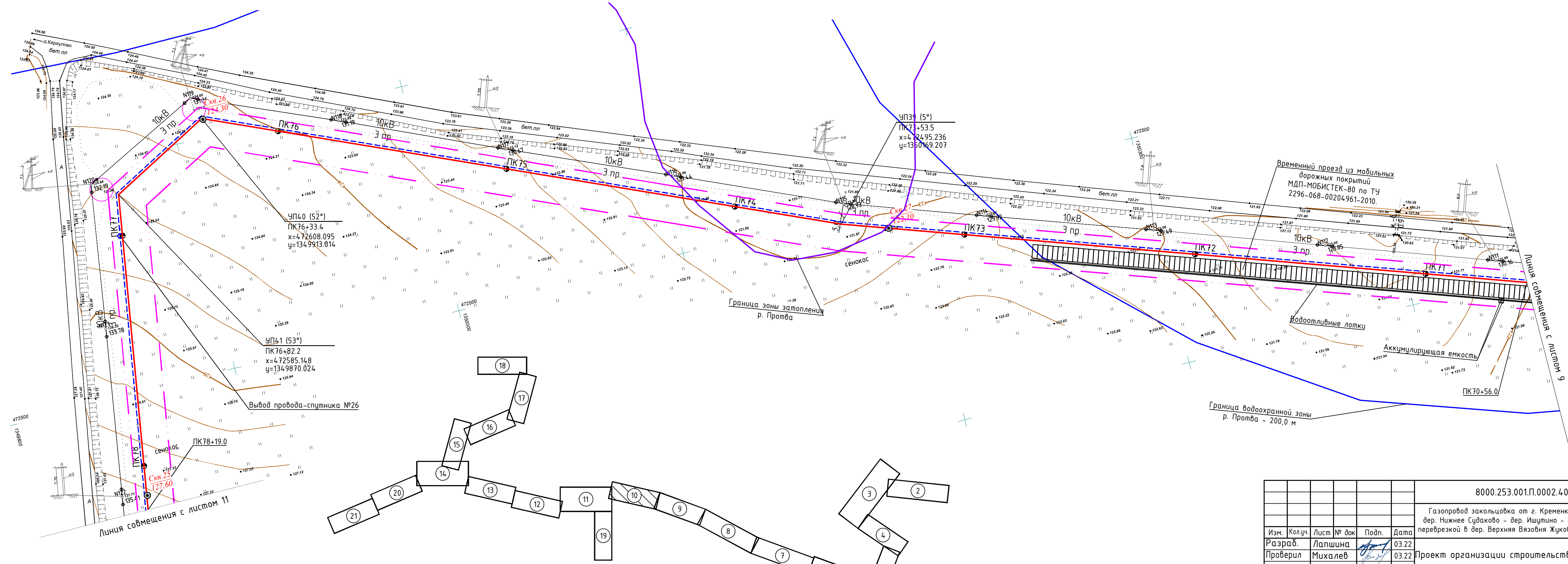
Рекультивация земель по лугу (ПК70+56.0-ПК78+19.0) протяженностью 763.0 м
