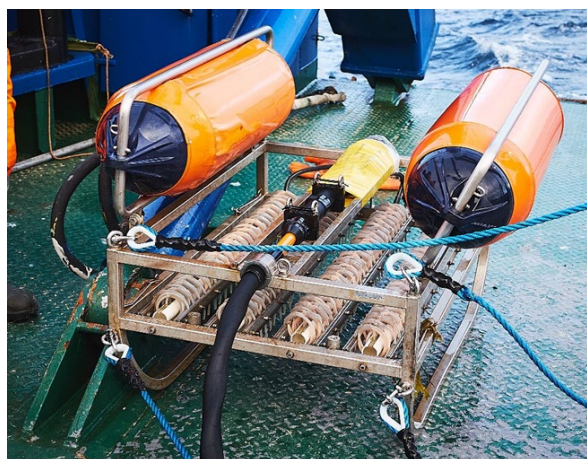
Рисунок 4.3-1 Излучатель Geo-Source 400 (слева) и излучатель Geo-Boomer 300-500 (справа), размещенные на катамаране
