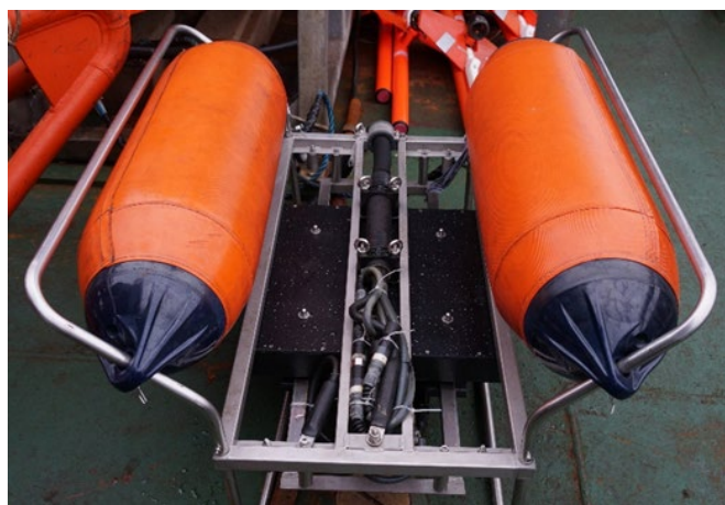
Рисунок 4.3-1 Излучатель Geo-Source 400 (слева) и излучатель Geo-Boomer 300-500 (справа), размещенные на катамаране
