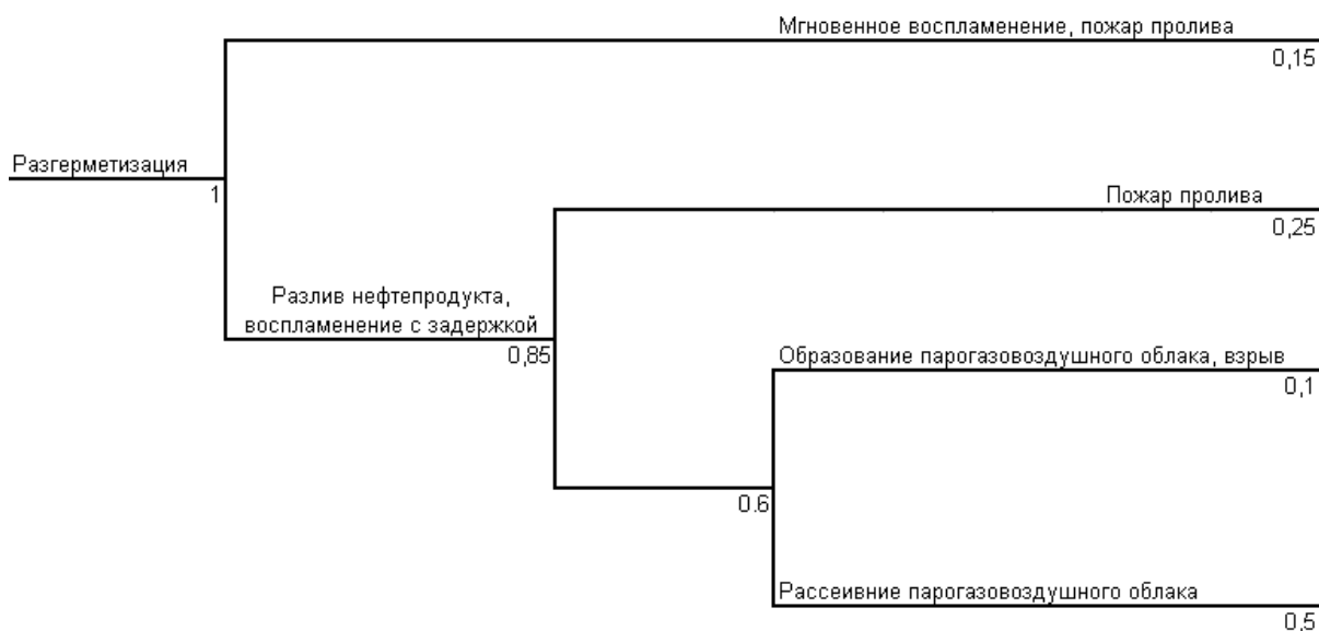
Рисунок 7. Логическая схема развития аварии на емкостном оборудовании
