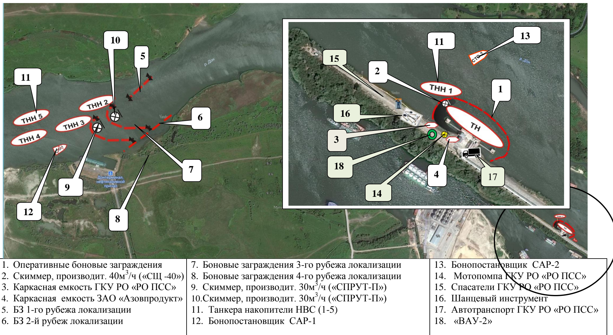
Рисунок 7.2- Рекомендуемая технологическая схема сбора нефтепродуктов при максимальном расчетном объеме разлива в районе причала №26 ЗАО «Азовпродукт»
