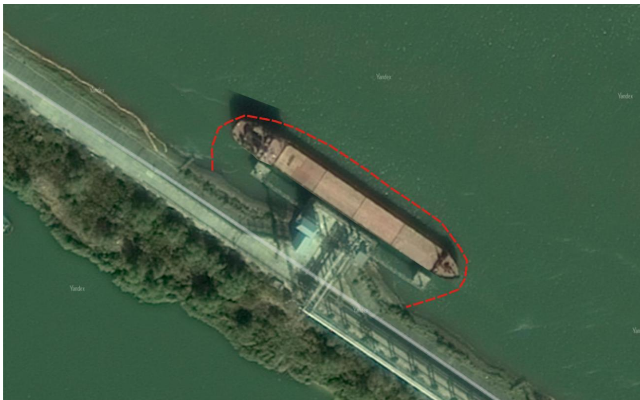
Рисунок 5.3.1- Схема постановки оперативных боновых заграждений при выполнении сливо-наливных операций
