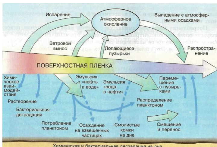
Рисунок 5.3.2. - Схема процессов распределения и разрушения нефтепродуктов, разлитых на воду
