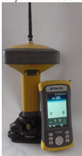
Спутниковый геодезический двухчастотный GPS / ГЛОНАСС приемник Topcon GR-3 с встроенными GSM и УКВ модемами
