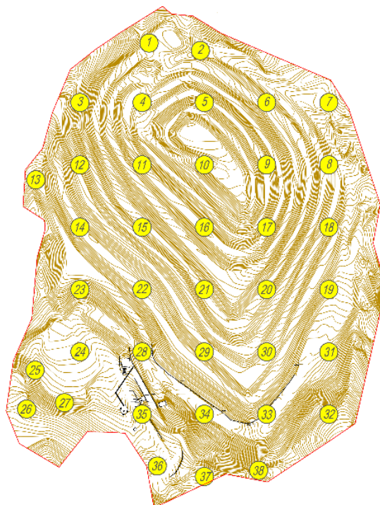
Рис. 1.2.9.5. расположение точек шпуровой газогеохимической съемки
