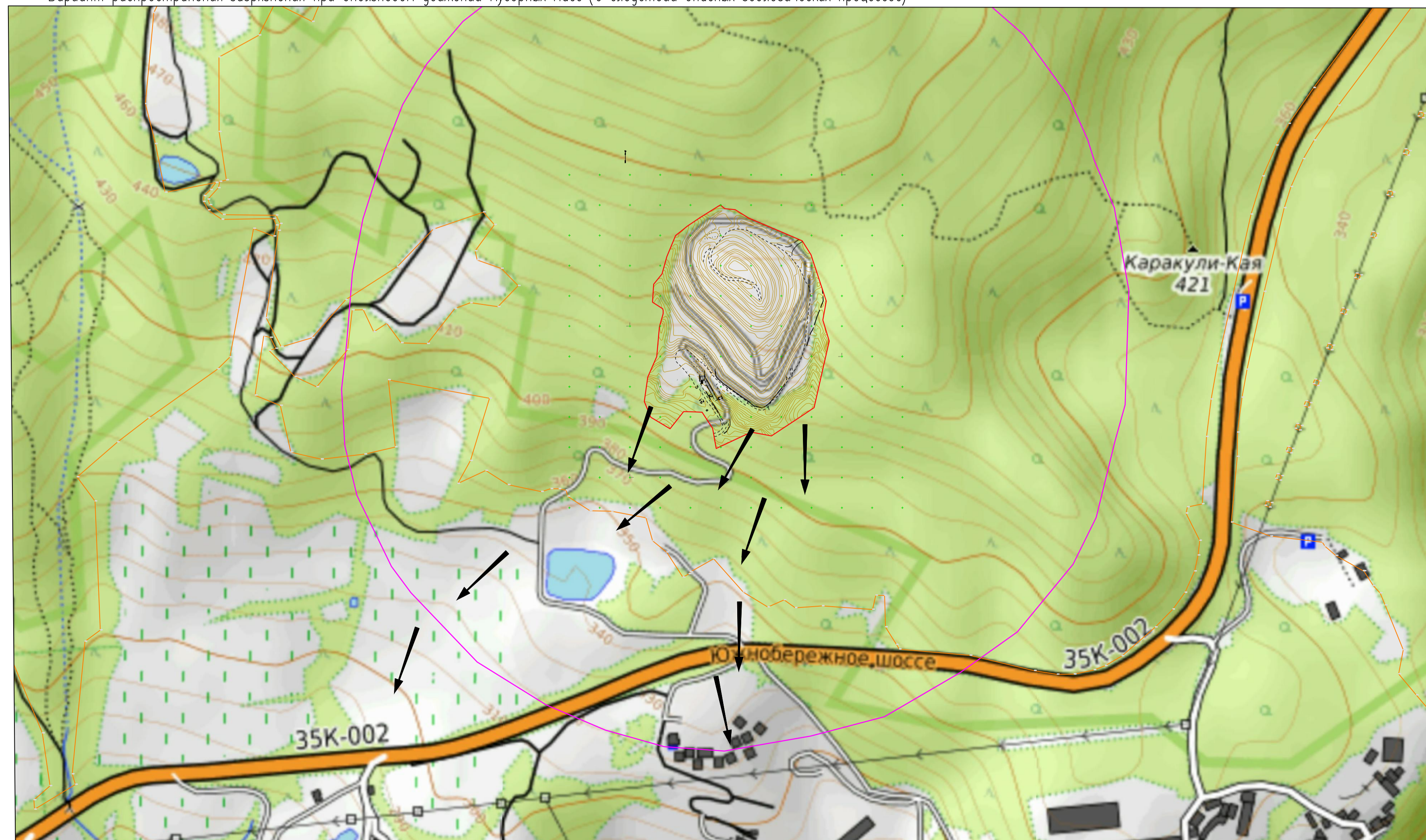
Вариант распространения загрязнения при оползневом движении мусорных масс (в следствии опасных геологических процессов)
