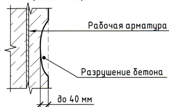
Поз. 2. Подготовка к демонтажу деструктивного бетона
