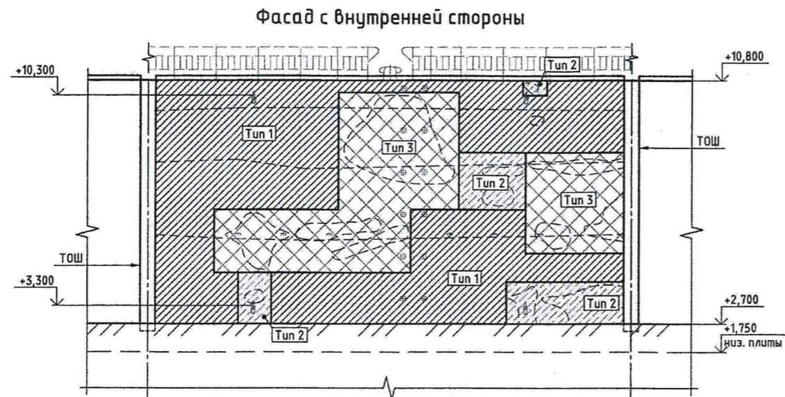
Северная ограждающая стена. Секция С-4. Вариант 1. Восстановление железобетонных конструкций. План
