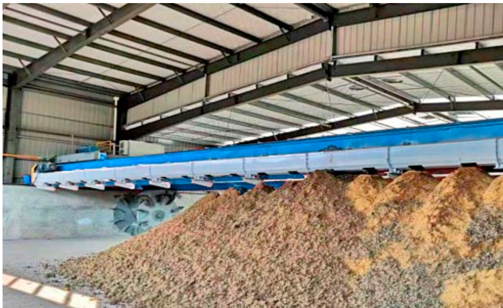
Рис. 7 – Формирование компостного бурта
