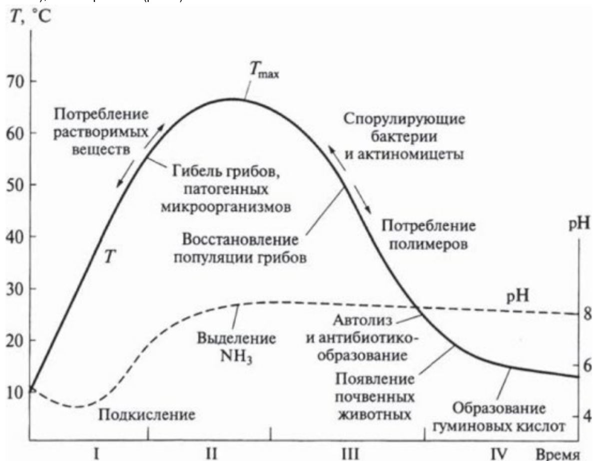
7. Рис. 1 – Стадии компостирования
