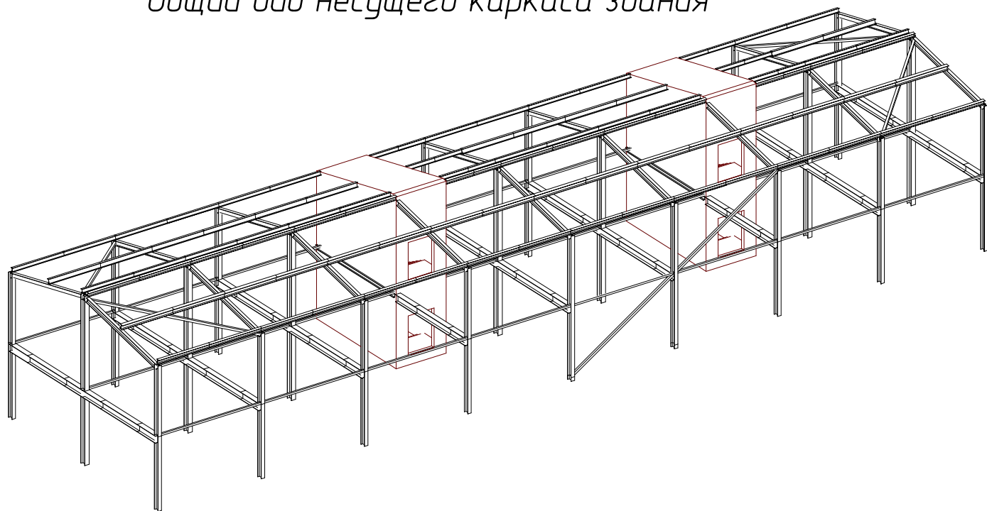
Общий вид несущего каркаса здания
