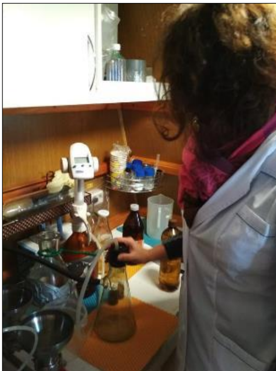
Рис. 4.2 - 8. Фильтрование пробы для определения концентрации хлорофилла a
