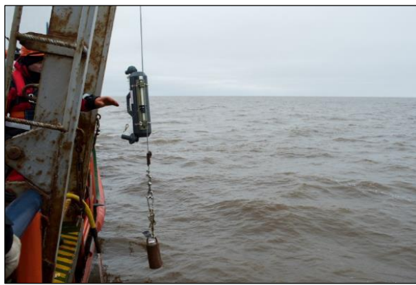
Рис. 4.2 - 3. Отбор проб воды на гидрохимические исследования с помощью батометра Нискина
