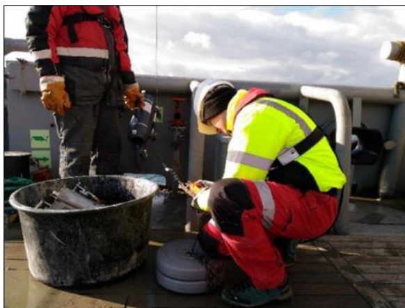
Рис. 4.2 - 1. Работа с CTD-зондом YSI Castaway
