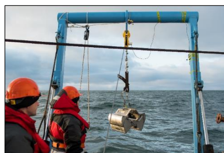
Рис. 4.2 - 6. Отбор проб грунта с помощью дночерпателя Океан-0,1
