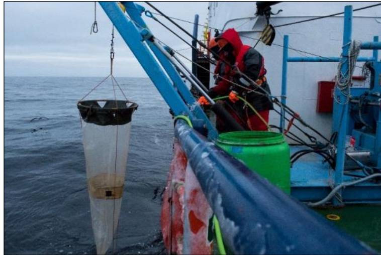
Рис. 4.2 - 10. Отбор тотальной пробы иктиопланктона, сетью ИКС-80
