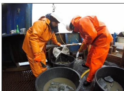
Рис. 4.2 - 5. Отбор проб грунта с помощью дночерпателя Ван Вина
