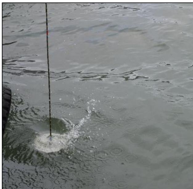
Рис. 4.2 - 2. Измерение прозрачности морских вод с помощью диска Секки
