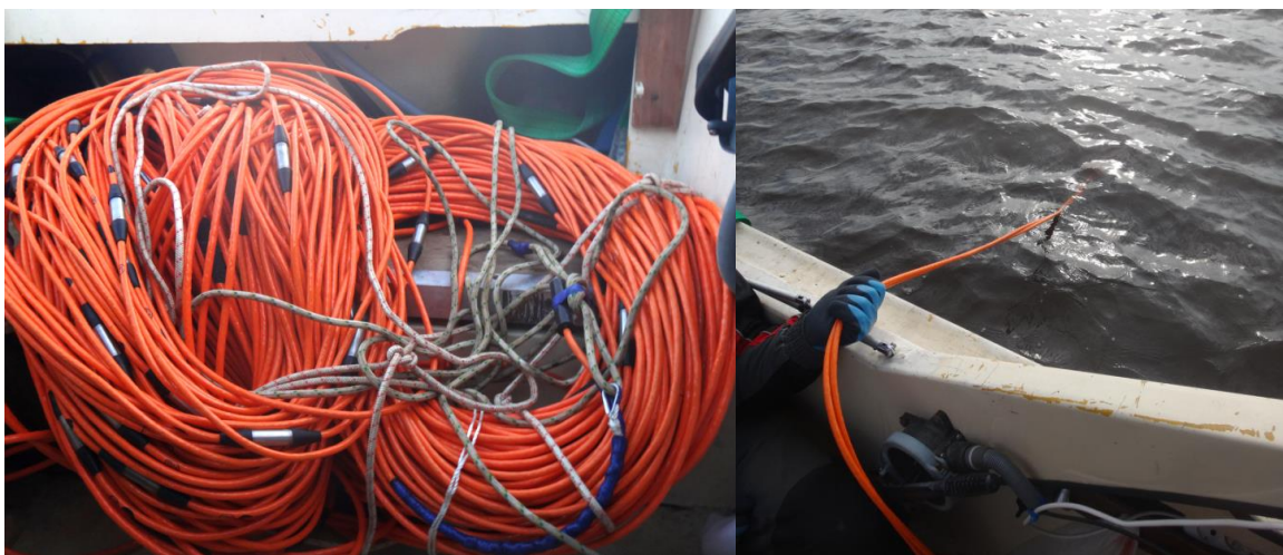
Рис. 4.3 - 1. Электроразведочная донная коса на палубе (слева) и во время работ (справа).
