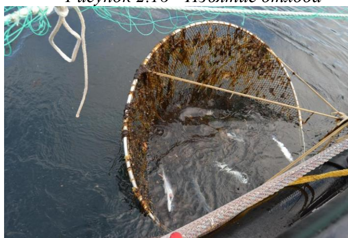
Рисунок 2.17 - Коллектор с поднятым отходом
