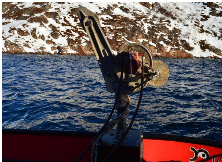
Рисунок 2.14 - Лебедка, установленная на рабочей лодке рыбоводов
