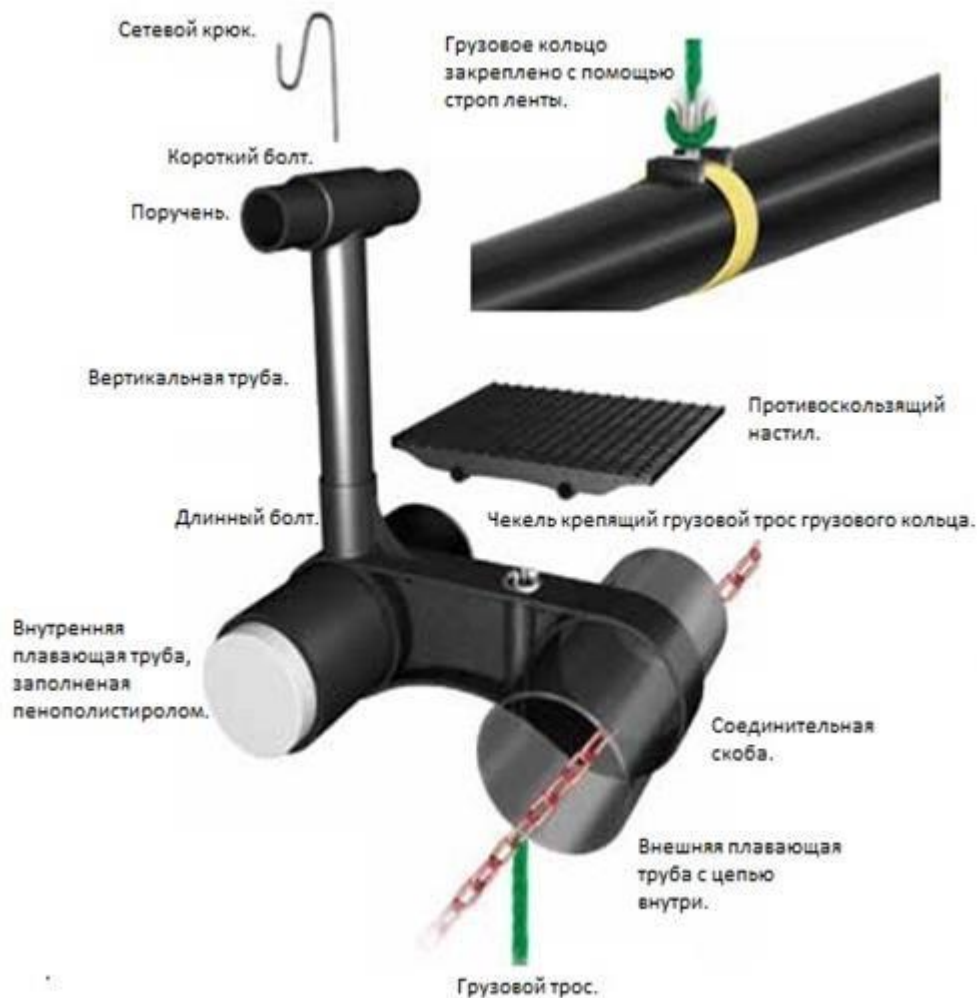
Рисунок 2.7 - Конструкция садка в разрезе
