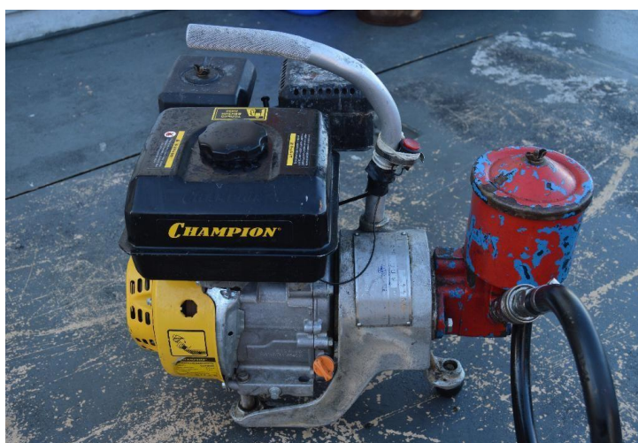
Рисунок 2.15 -Силовой агрегат (двигатель и насос) лебедки
