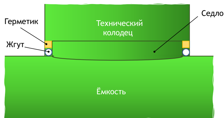
Рис. 19. Установка технического колодца
