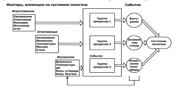
Накопление газа в теле свалки вызывает взрывы и горение ТБО. При горении свалки, если
