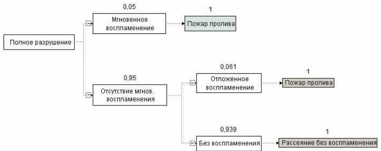
Рисунок 1 – Разгерметизация цистерны ТЗ
