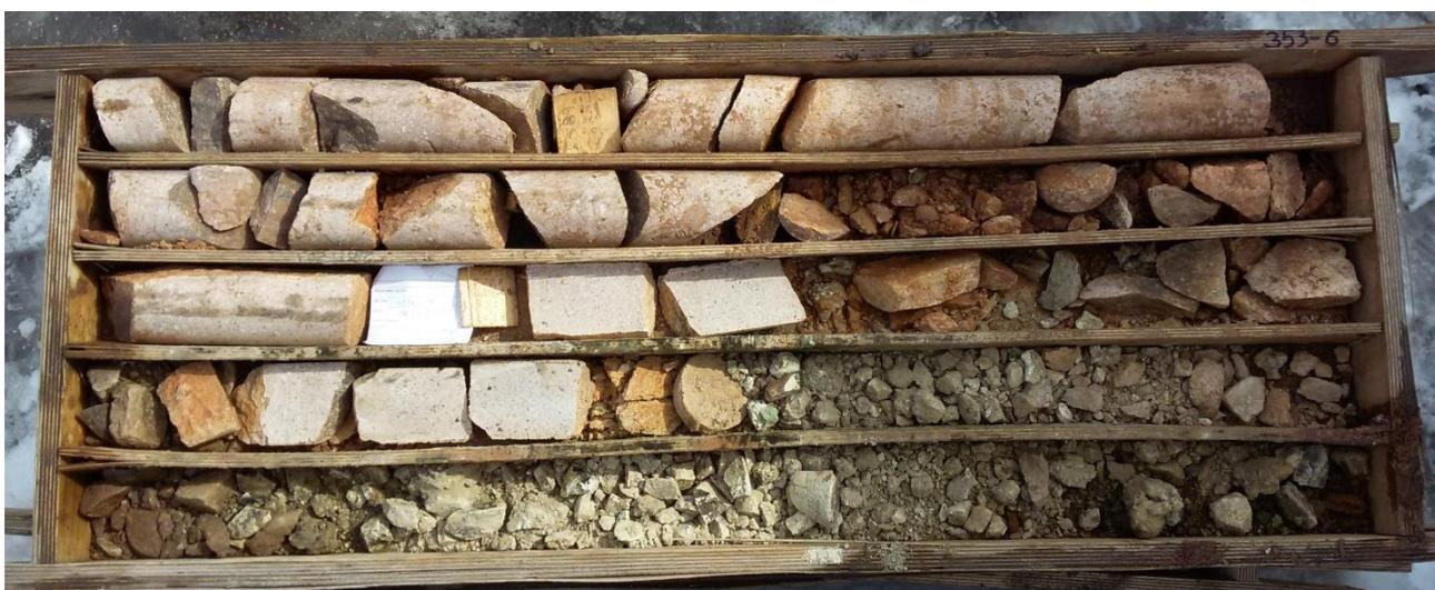
Рисунок 5.5 – Керновый ящик скважины 353а инт. 26,1-31,4 м
