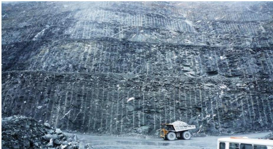
Рисунок 5.14 – Результат применения щадящего взрывания и предварительного щелеобразования при постановке уступов на проектный контур
