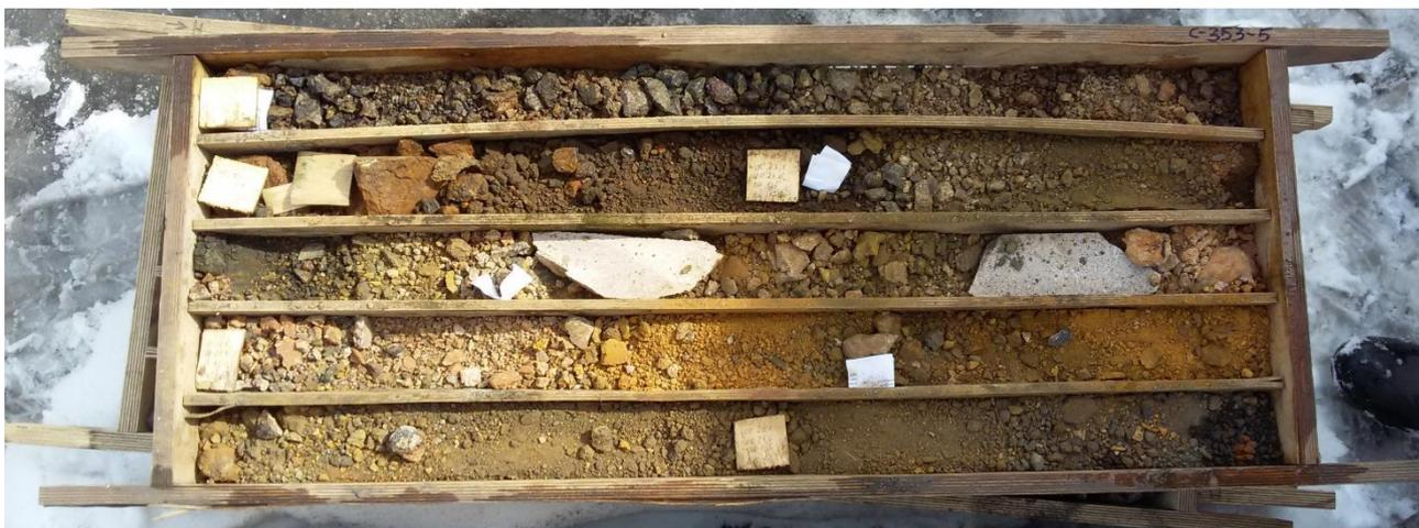
Рисунок 5.4 – Керновый ящик скважины 353а инт. 21,1-26,1 м
