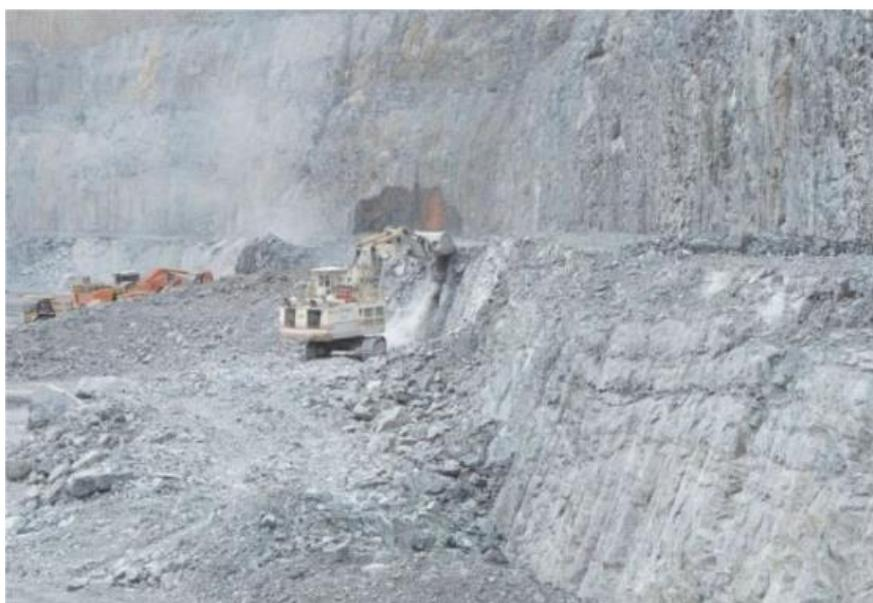
Рисунок 5.12 – Оборка уступов экскаватором
