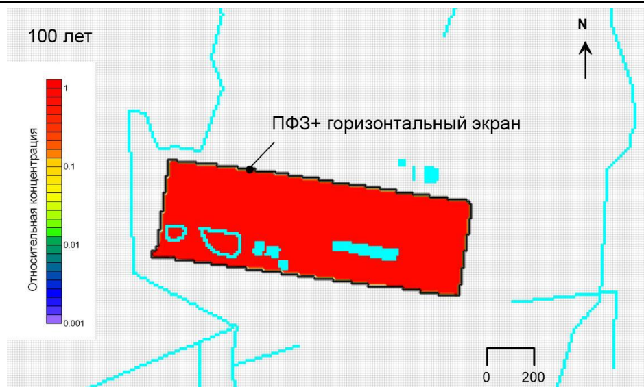
Рисунок 3.4.3 – Движение ореола загрязнения при создании ПФЗ и горизонтального экрана
