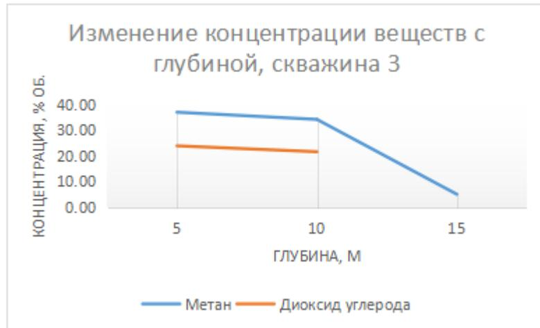
Рисунок 7.3.4 - Изменение содержания CH<sub>4</sub> и CO<sub>2</sub> в об. % с глубиной в скважинах
