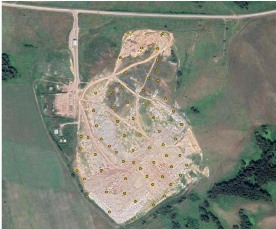
Рисунок 7.3.2 – Шпуровая газогеохимическая съемка
