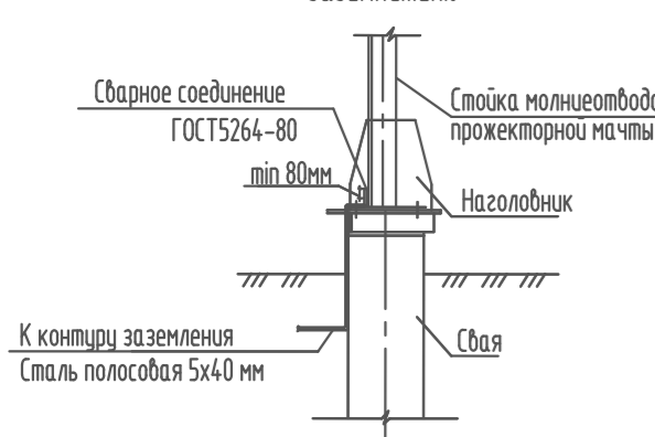
Узел присоединения молниеотвода к заземлителю
