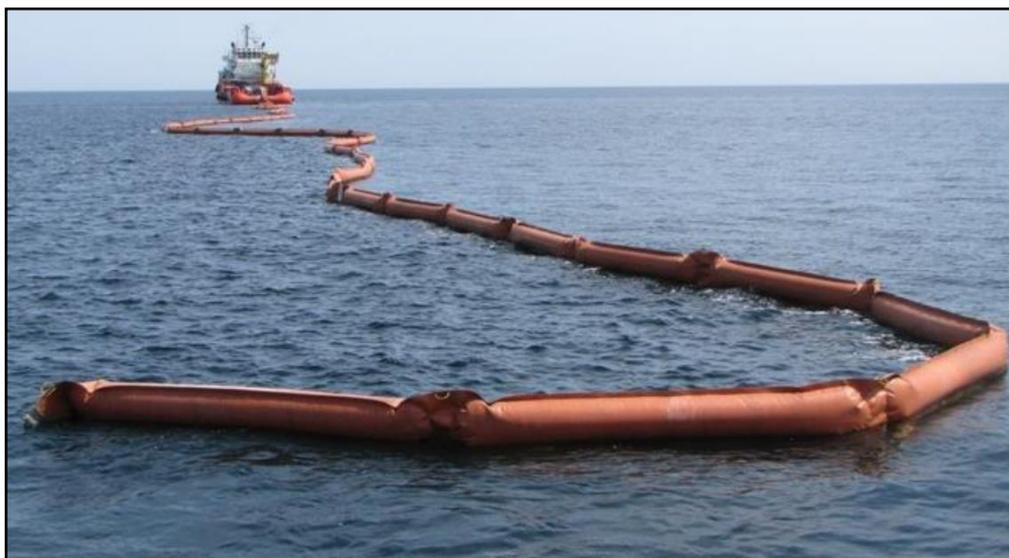
**Рисунок 14.8. Внешний вид боновых заграждений RubberMax 1500**
