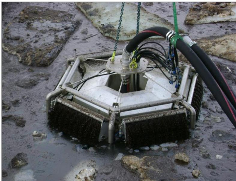
Рисунок 14.6. Внешний вид нефтесборной системы POLAR BEAR (полярный медведь)
