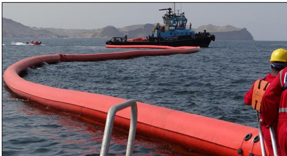
Рисунок 14.2. Внешний вид боновых заграждений Markleen UNIBOOM X1500
