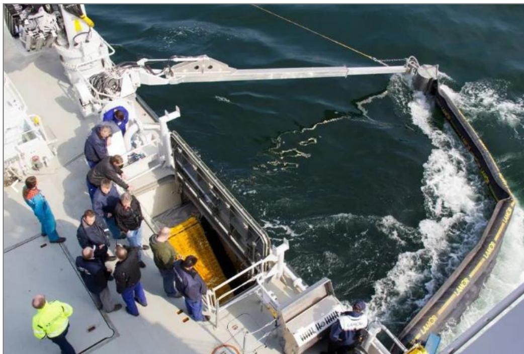
Рисунок 14.11. Внешний вид нефтесборной системы «Lamor LORS 5c»
