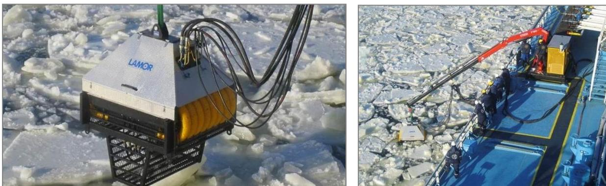
Рисунок 14.12. Внешний вид нефтесборной системы lamor Arctic
