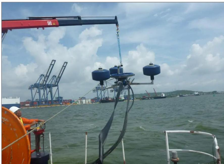
Рисунок 14.9. Внешний вид нефтесборной системы Lamor weir
