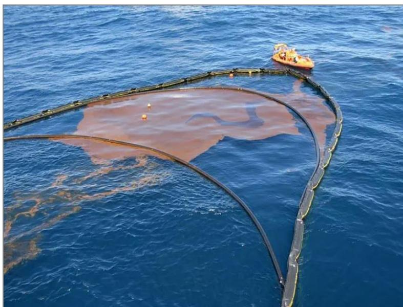
Рисунок 14.3. Внешний вид нефтесборной системы DESMI Speed-Sweep
